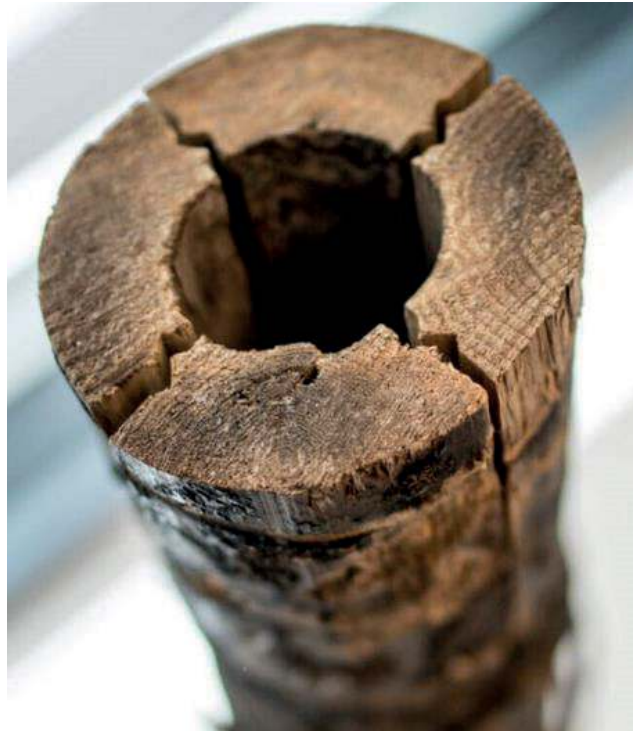
Figur 3: Vannrør av tre funnet i Halden
